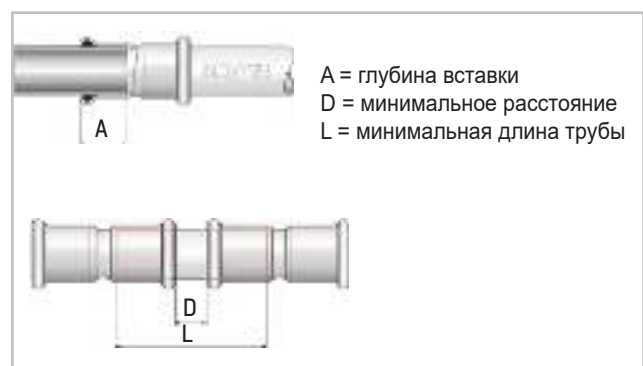
Рис. 27. Глубина вставки и минимальные размеры.
